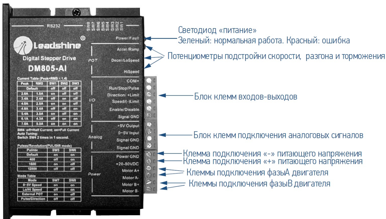
Рис. 2. Схематичное расположение контактов DM805-AI
