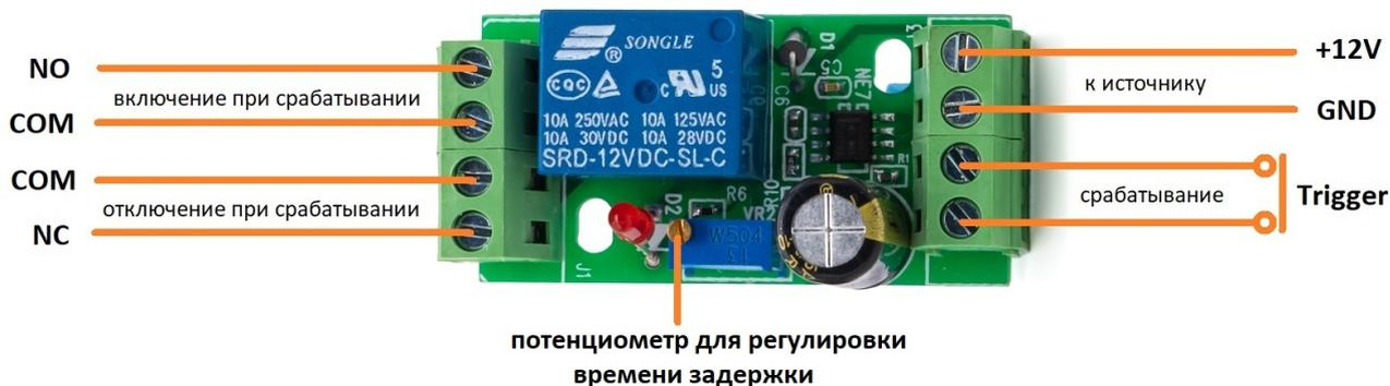
Рис. 1. Схема подключения реле с задержкой TDRM01-12V
