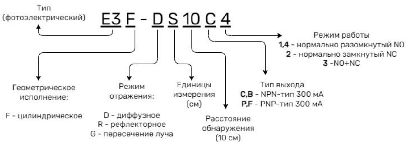
Рис. 12. Расшифровка значения модели датчика
